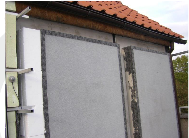
Widok przegrody na stanowisku badawczym
