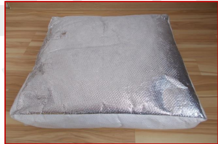
Przykład prototypu płyty z powłoką refleksyjną w postaci pojedynczej maty
