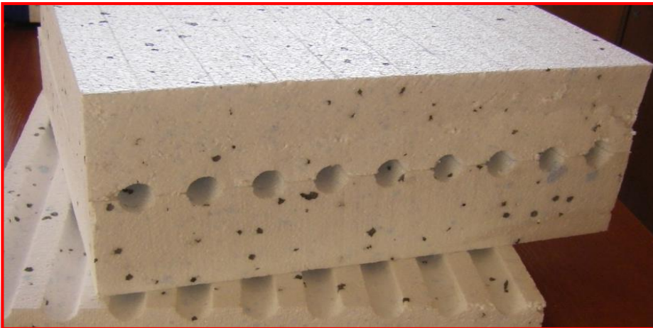
Przykład prototypu płyty z perforacją \phi 3mm o przekroju kołowym
