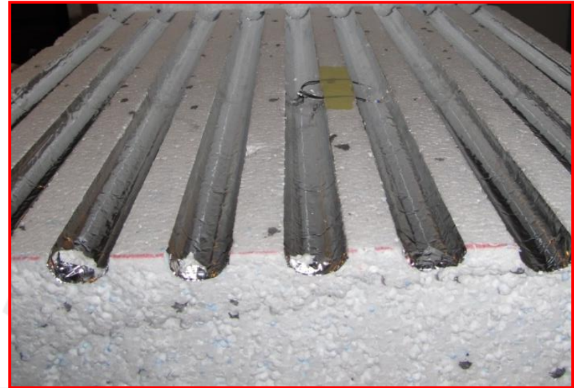
Przykład prototypu płyty z powłoką niskoemisyjną
